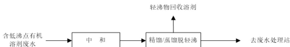
图 4.1-1 含二氯甲烷废水预处理工艺流程
